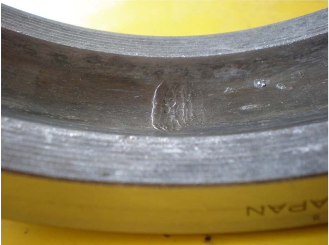
Рис. 6. Повреждения внешнего кольца подшипников
